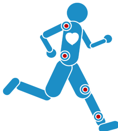
Figura 1. Ubicación de los dispositivos inerciales en los participantes de esta investigación.
